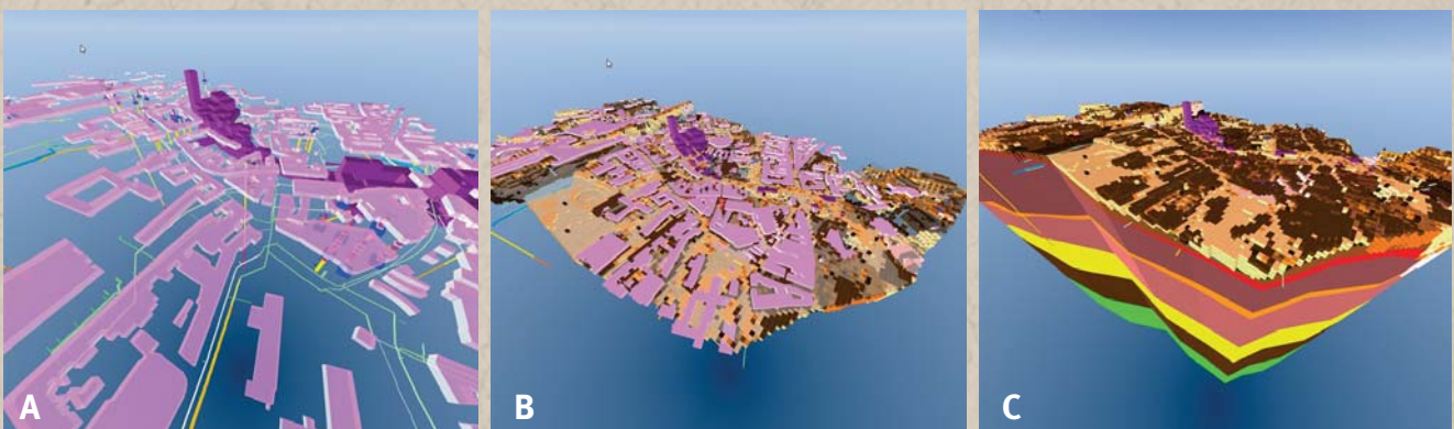
Figur 11. A. Huse og ledningsnet. B. Antropogent lag (huse og fyld). C. Samlet bygeologisk model.
