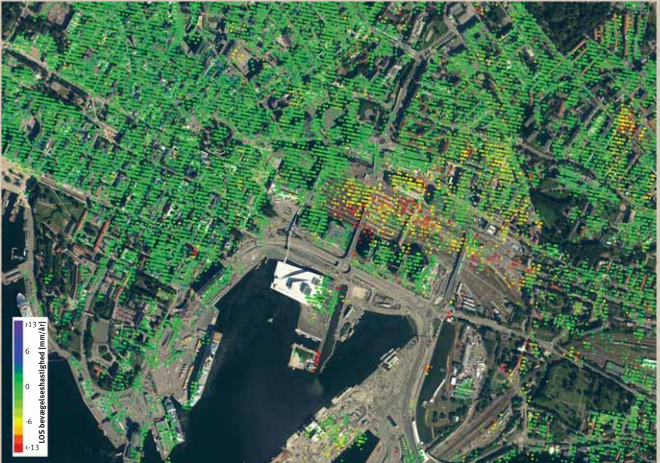
Figur 14. Data fra Sentinel-1 satellit opsamlet mellem 26. december 2014 og 28. oktober 2016 viser at dele af Oslo Centralstation synker 10-15 mm/år i den synsretning, som satellitten ser bygningen fra. Dette oversættes til en vertikal sænkning på 12-18 mm/år.
