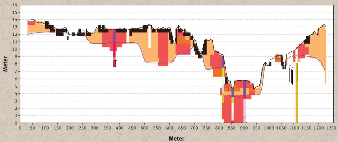
Figur 10. Antropogen modellering med indarbejdelse af kældre m.m. De brune farver er ler, røde er sand og sortbrune svarer til hydraulisk set uigennemtrængelige lag (fx bygningskældre og fundamenter).
